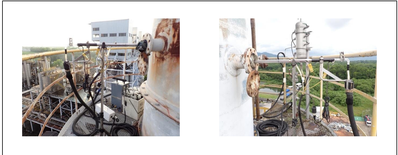
ภาพที่ 3.4.2-1 แสดงการตรวจวัดคุณภาพอากาศจากปล่องระบายอากาศ
